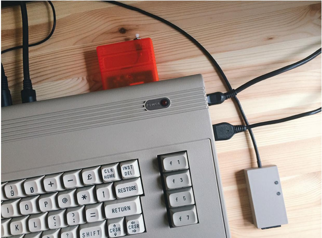
Epyx Fastload Reloaded Prototype mit SD2IEC (TFW8B). (Bild: Stefan Vogt)
