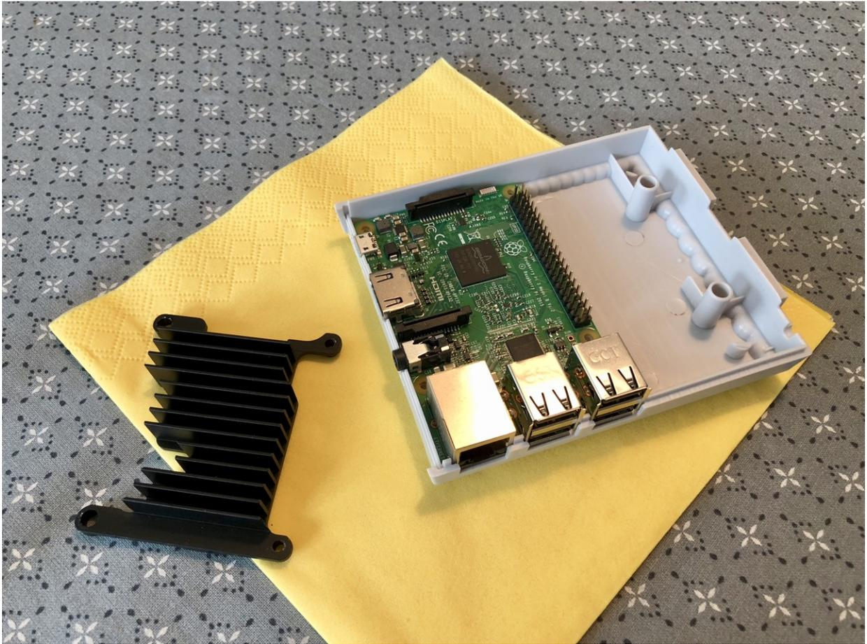
Der Pi passt perfekt in das Kintaro-Gehäuse. Links daneben: der Kühlkörper (Heatsink) für die CPU.
